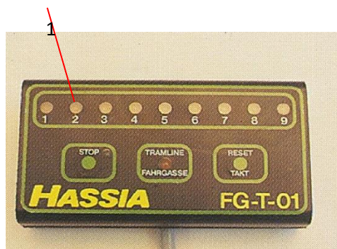
Фиг. 1. Системи за контрол на точна и слята сеитба от първо поколение:
