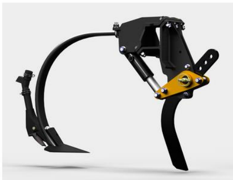
Фиг. 4. Сееща секция с лаповиден ботуш и прорязващ нож пред него
