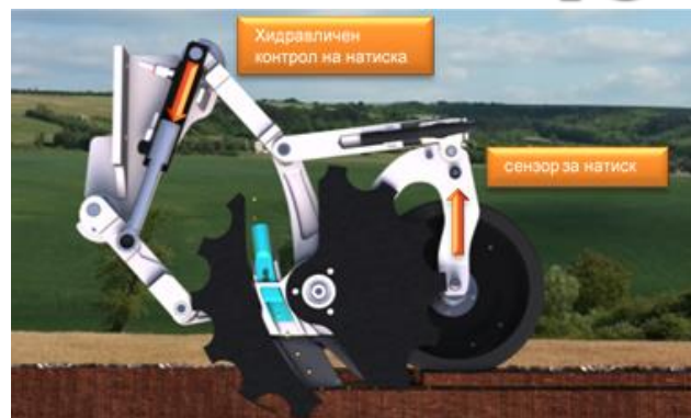
Фиг. 12. Многошарнирно окачване
